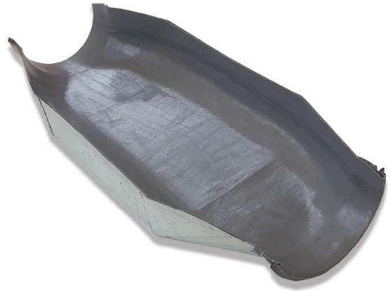
Genomskärning av rör tätat med Linerventmetoden
